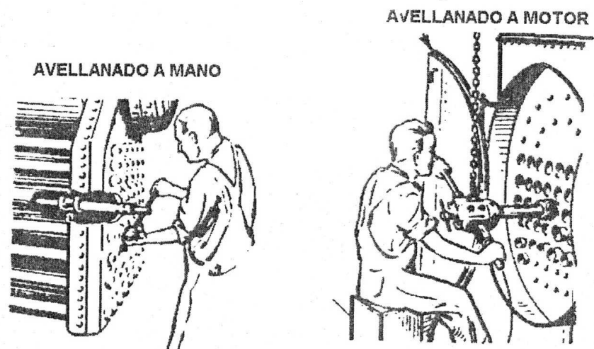
Fig. 21: Los expansores pueden ser manuales o a motor
