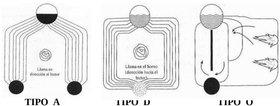
Fig. 06: Caldera de tubos curvos
