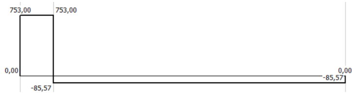
Figura 33. Diagramas de cortante plano Y-Z
