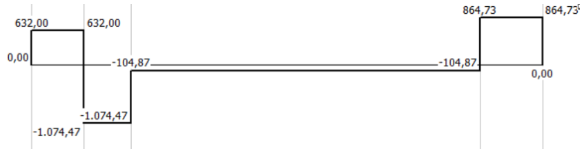
Figura 36. Diagramas de esfuerzo cortante plano X-Z
