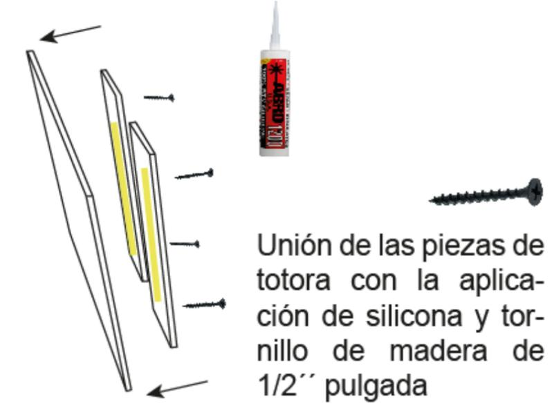
Unión de las piezas de totora con la aplicación de silicona y tornillo de madera de 1/2" pulgada
