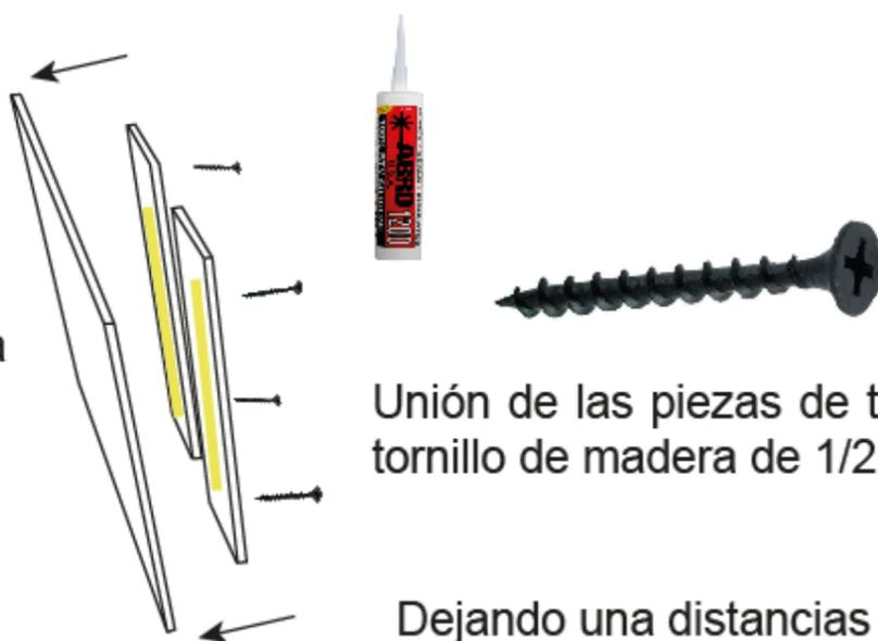
Unión de las piezas de totora es con la aplicación de silicona y tornillo de madera de 1/2'' pulgada
