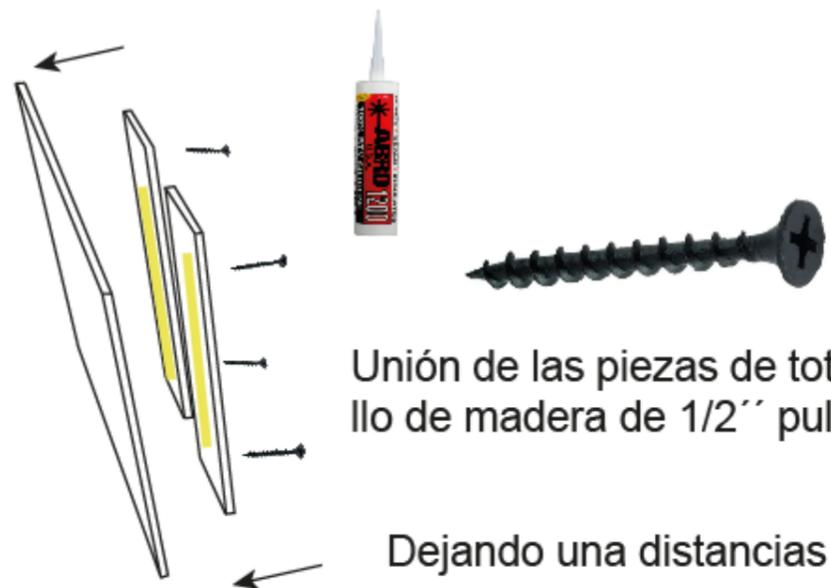
Unión de las piezas de totora con la aplicación de silicona y tornillo de madera de 1/2" pulgada
