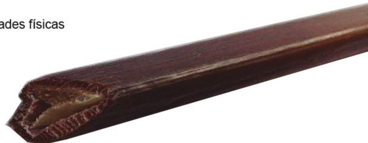
Una de las principales cualidades físicas de la totora es su capacidad de impermeabilidad y sus cámaras de aire al interior de su estructura porosa, lo que la vuelve un material muy ligero y aislante térmico y acústico. (Hidalgo, F. 2016).
