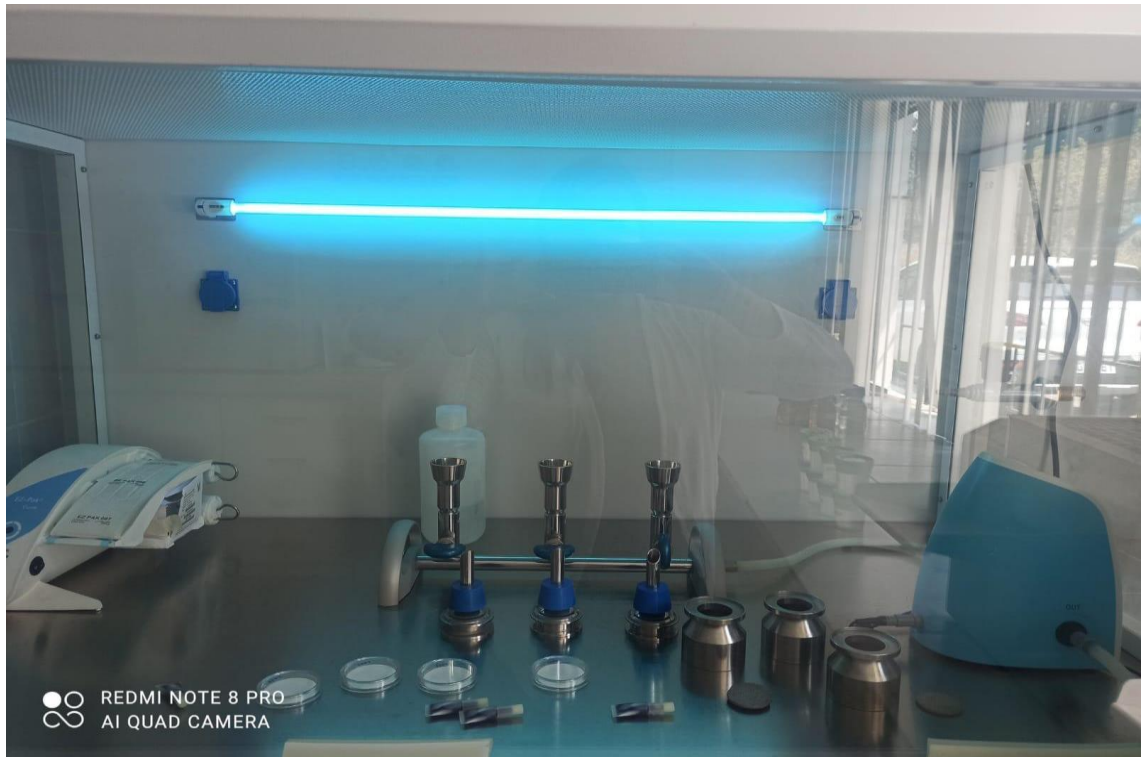
Ilustración 7. Materiales y equipos del método filtración por membrana Laboratorio microbiológico EMAPA
