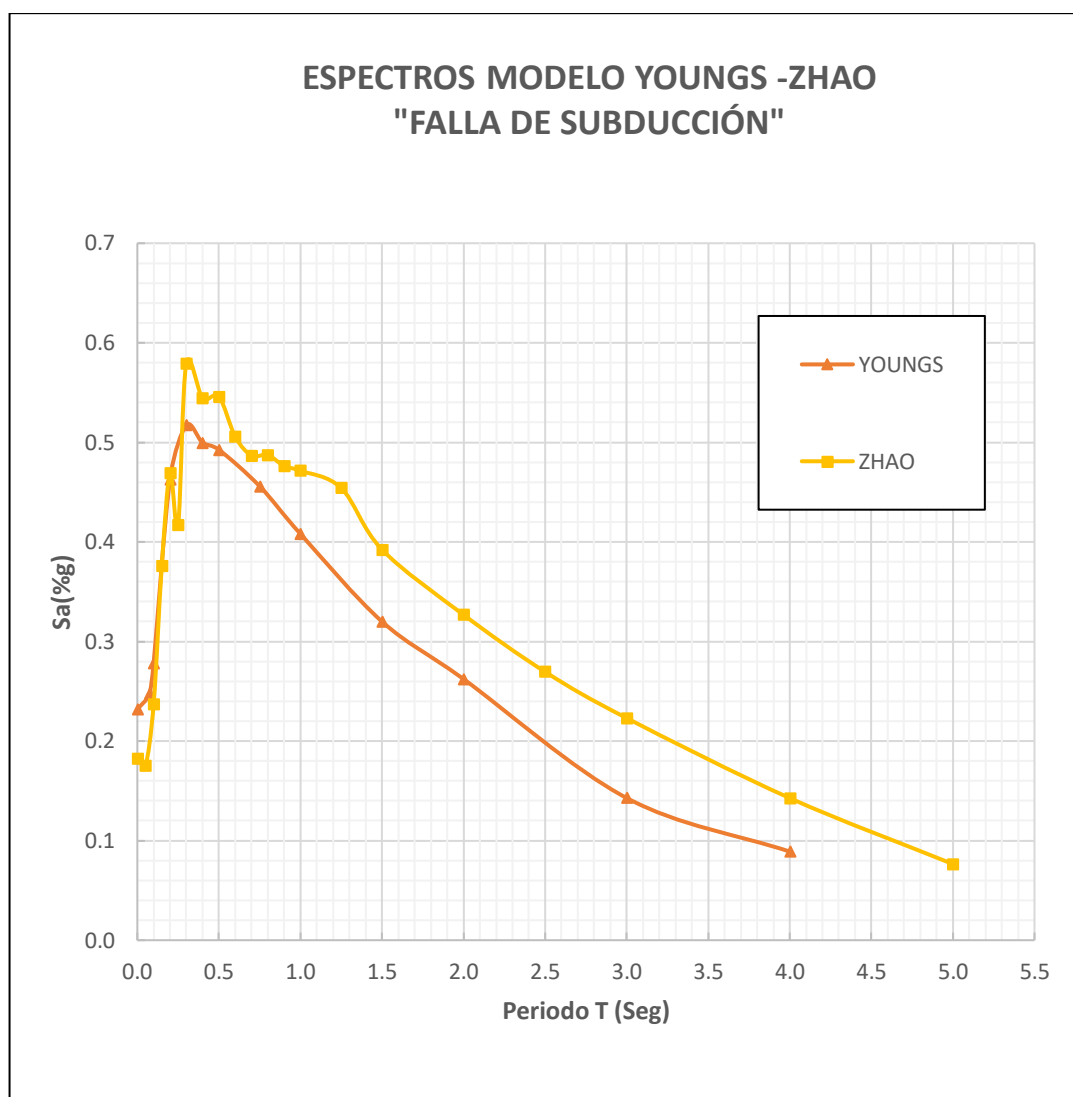
Figura 33. Espectros de aceleración obtenidas con el modelo Youngs y Zhao, para la falla de Subducción.
