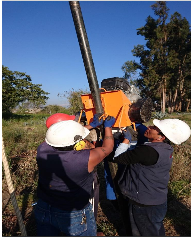
Fotografía 4. Ejecución ensayo SPT
