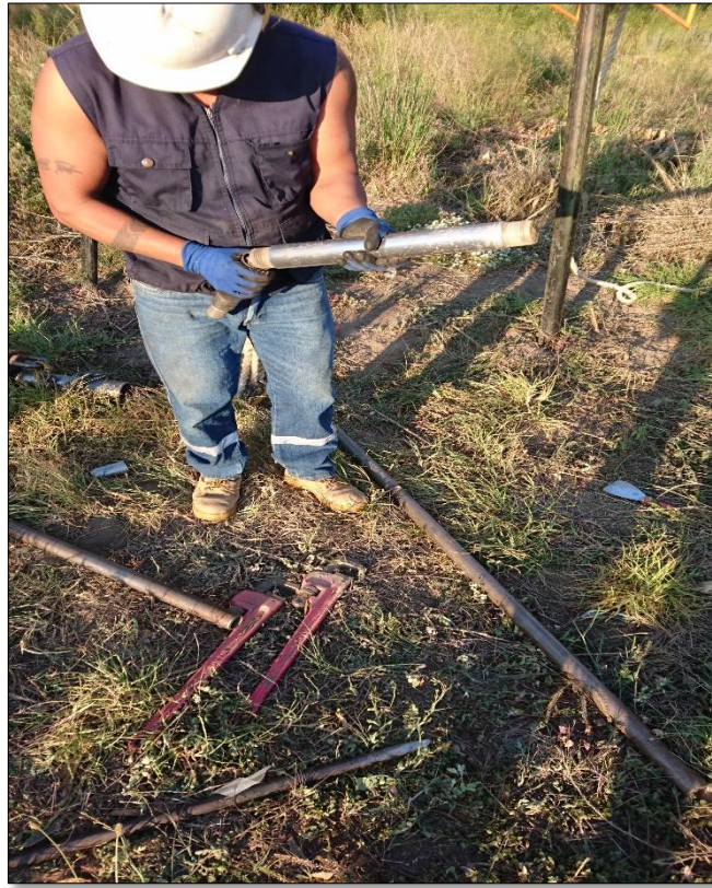
Fotografía 6. Extracción de muestras in situ
