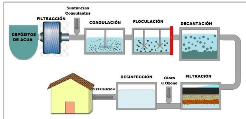
Figura 7. Esquema general de potabilización del agua
