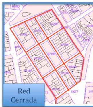
Figura 10. Red de distribución cerrada o mallada
