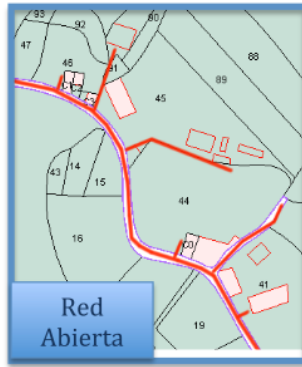
Figura 9. Red de distribución abierta o ramificada
