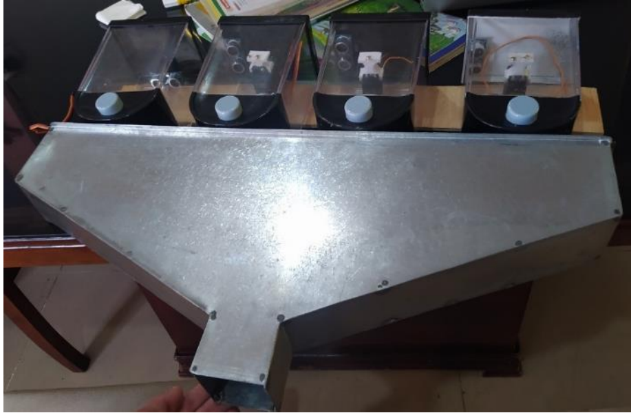
Figura 63. Tolva Invertida Implementada – Vista 1
