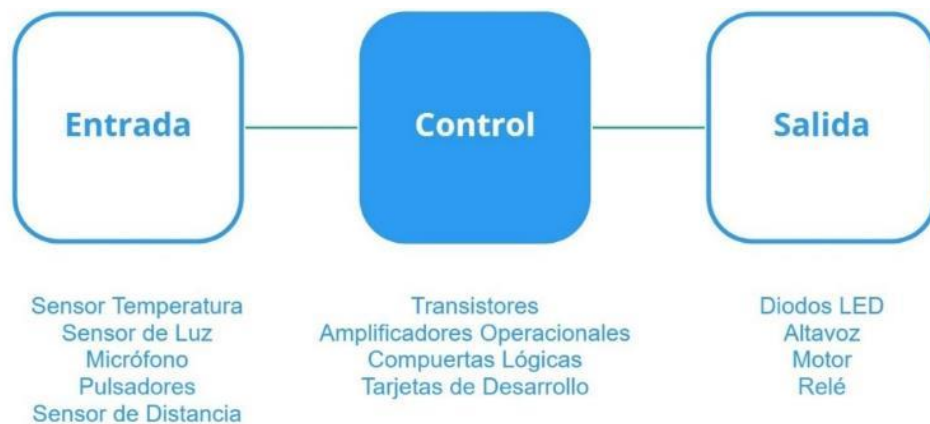
Figura 1. Estructura del Sistema Electrónico [14]
