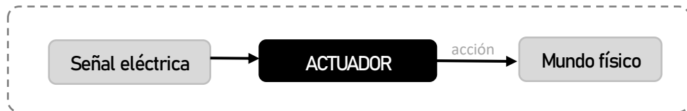
Figura 7 Diagrama de bloques del funcionamiento de un actuador.
