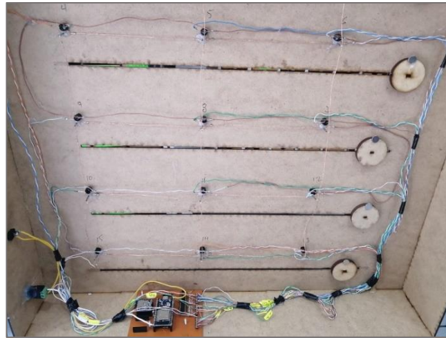
Figura 52 Montaje y conexión de los sensores y LEDs en la estructura de la sección Senderos Mágicos. Fuente: Investigador
