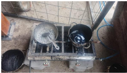
Calentamiento de agregados y bitumen
