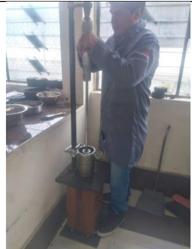
Compactación de la mezcla
