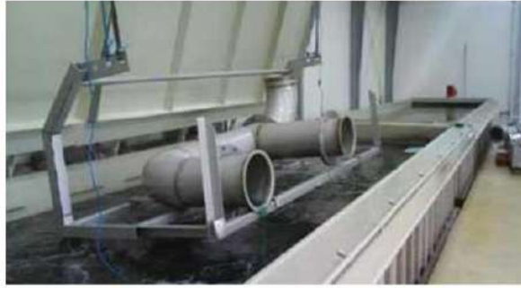
Figura 13: Limpieza Química (SSPC – SP8) [14].
