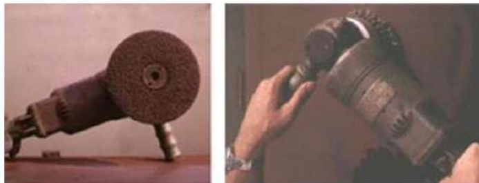
Figura 10: Limpieza Mecánica (SSPC – SP3) [14].
