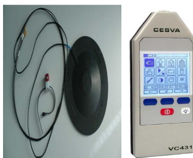
Fig.3: Acelerómetro AC033 y Medidor VC431
