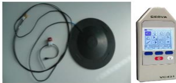
Figura 6. . Medidor de vibración marca CESVA modelo VC431 y el Acelerómetro
