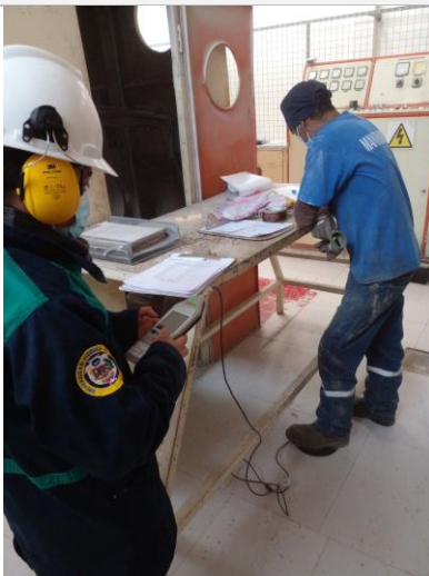
Medición de los niveles de vibraciones transmitidas al cuerpo completo
