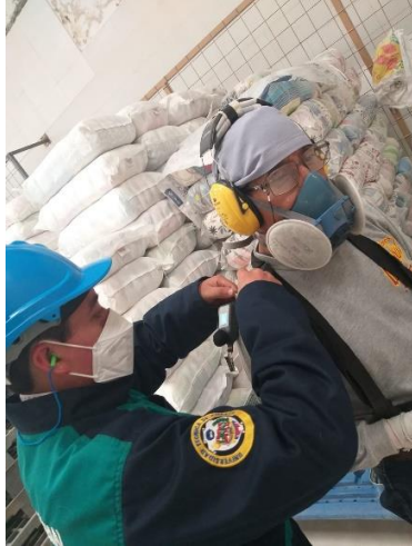
Colocación del equipo de medición de ruido a los trabajadores del área de pastificio
