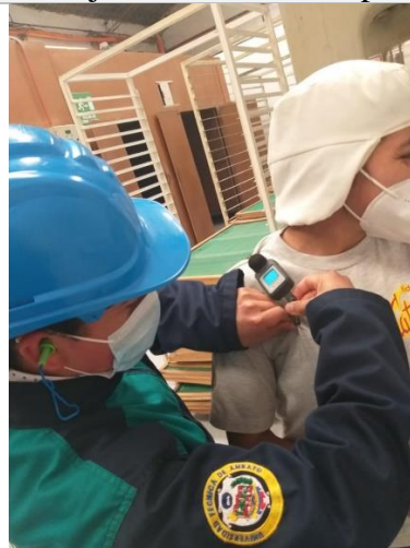
Medición de los niveles de vibraciones transmitidas al cuerpo completo
