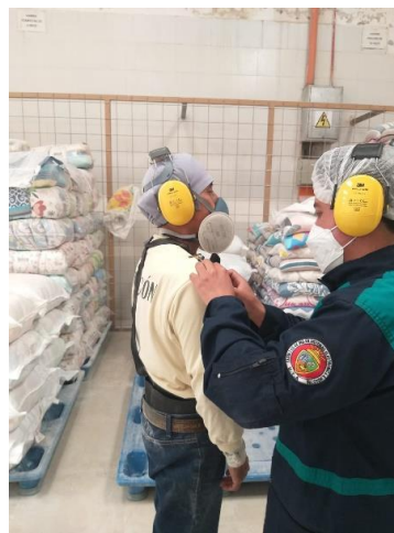
Colocación del equipo de medición de ruido a los trabajadores del área de pastificio
