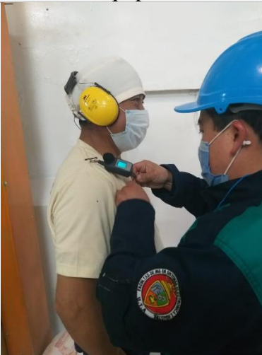
Medición de los niveles de vibraciones transmitidas al cuerpo completo
