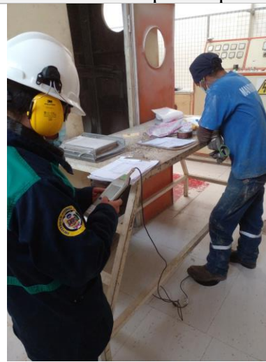
Medición de los niveles de vibraciones transmitidas al cuerpo completo
