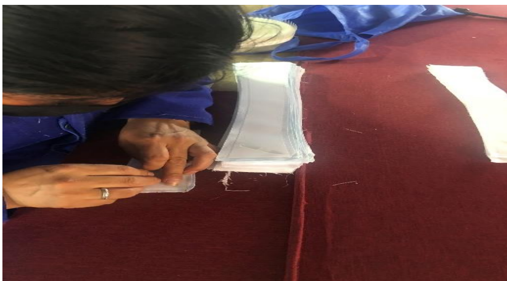
Figura 30 Colocación de la ballenita
