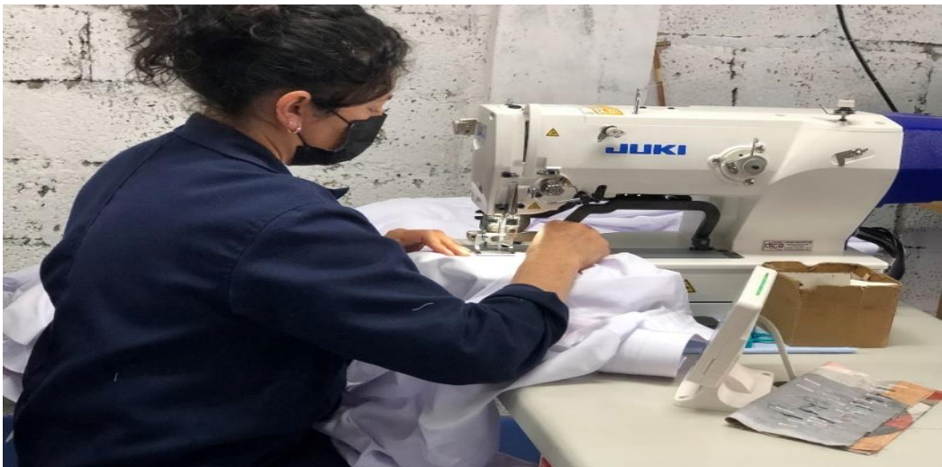
Figura 44 Realización de ojales
