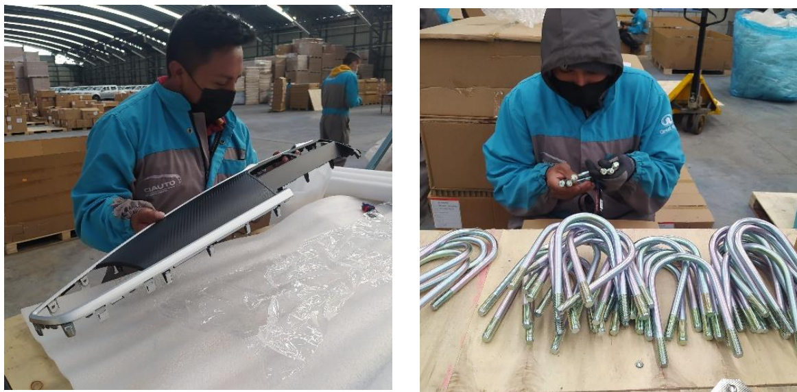
Figura 23. Verificar puntos de anclaje, vinchas, o-ring y rosca
