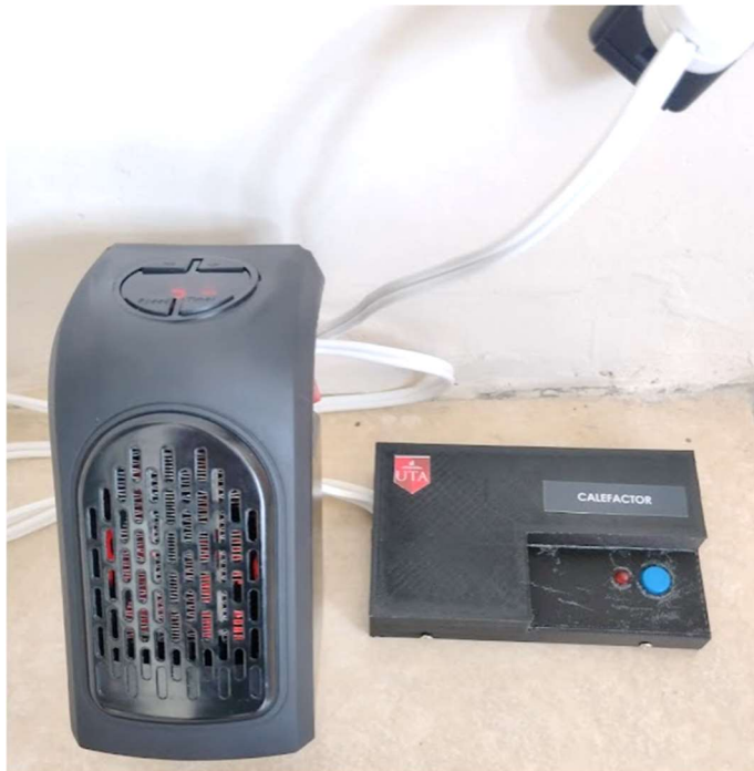
Figura 101. Conexión del módulo de control del calefactor Elaborado por: El Investigador
