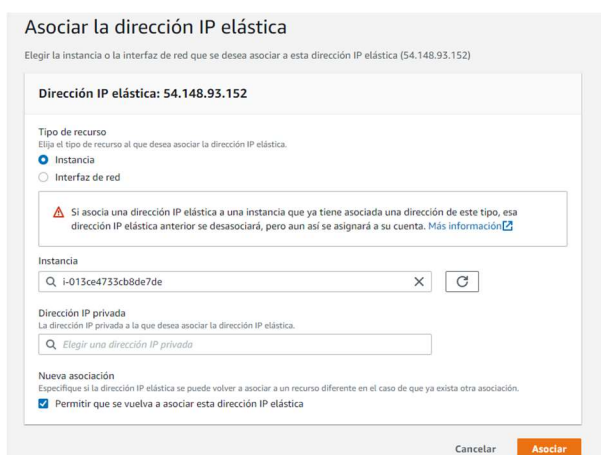
Figura 14. Asignación de IP elástica al servidor en la nube.
