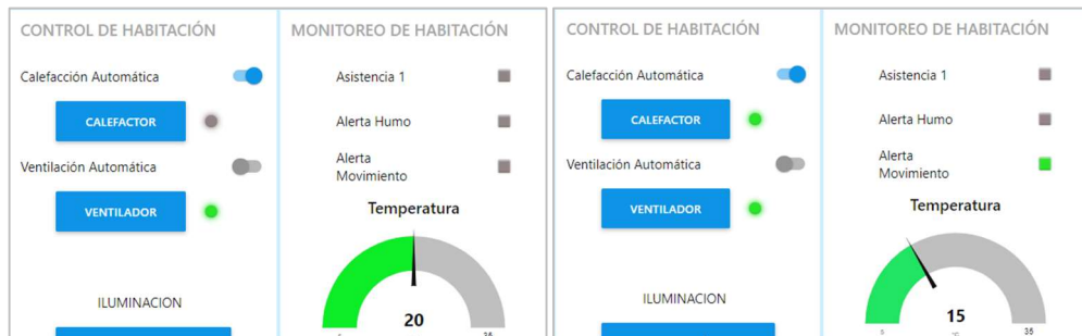
Figura 120. Funcionamiento de Calefacción automática
