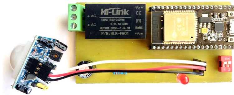
Figura 34. Montaje de componentes del módulo detector de movimiento.
