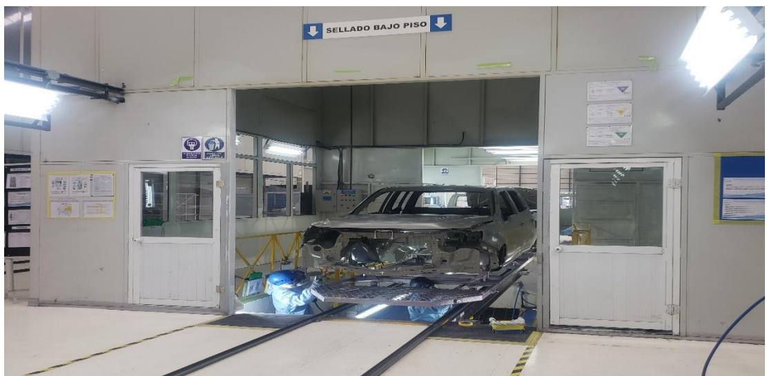
Figura 23. Estación de sellado bajo piso.
