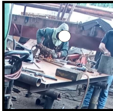
Figura 17. Desprendimiento de partículas o fragmentos
