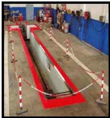
Figura 48. Foso de inspección con señalización [56]
