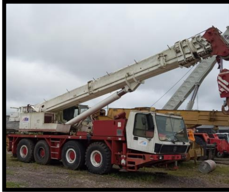
Figura 25. Grúa telescópica sobre camión
