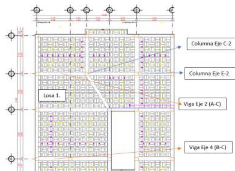
Figura 36: Zona de ensayo esclerométrico de losa, vigas y columnas del nivel N +3.42 m
