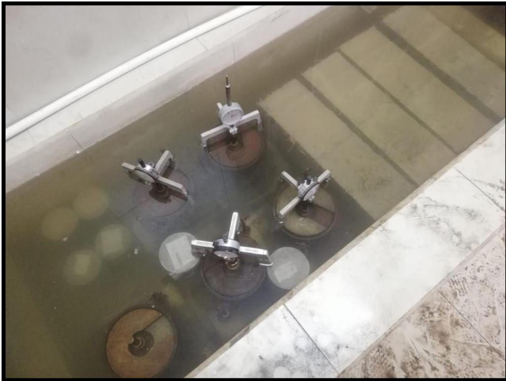
*Figura 69: Moldes de CBR en la cámara de curado.*
