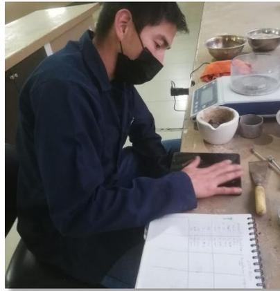
*Figura 28: Ensayo Limite Plástico.
