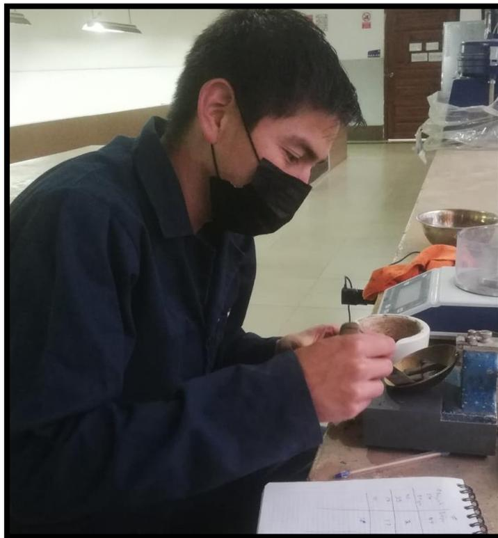
*Figura 65: Ensayo de límite líquido.*
