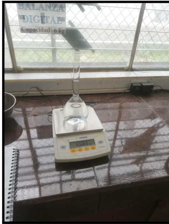
*Figura 64: Pesando la probeta con agua para el ensayo de la Gravedad Especifica.*
