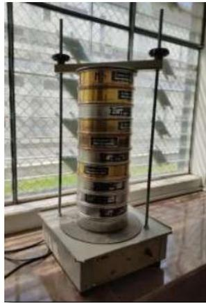
*Figura 26: Análisis Granulométrico.
