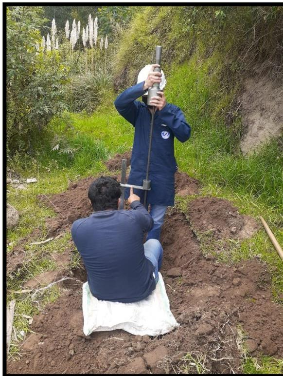
*Figura 63: Ensayo de DCP en la vía Cusubamba – punto 1*
