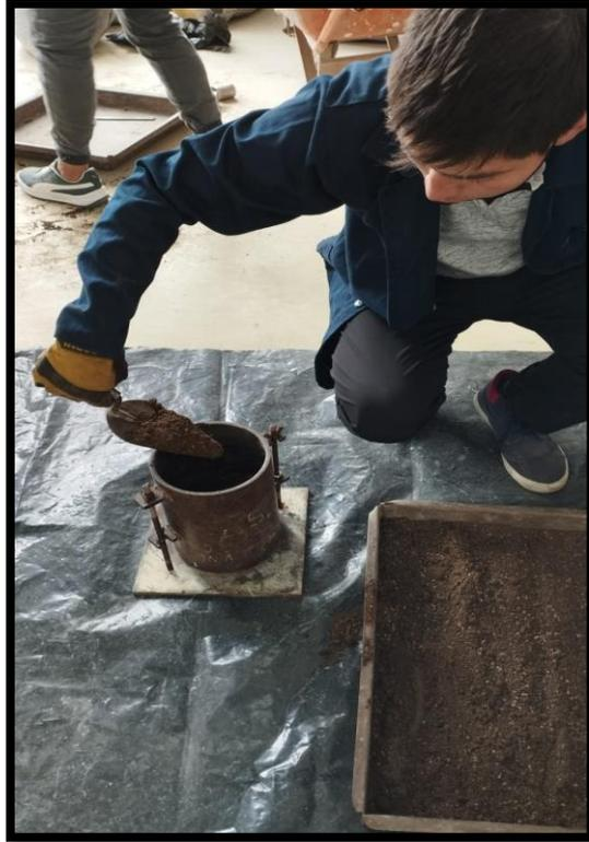
*Figura 68: Ensayo de CBR de Compactación*
