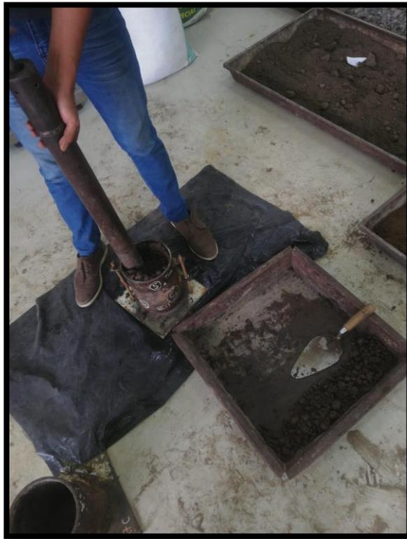
*Figura 67: Ensayo de Proctor Modificado Tipo "B"*
