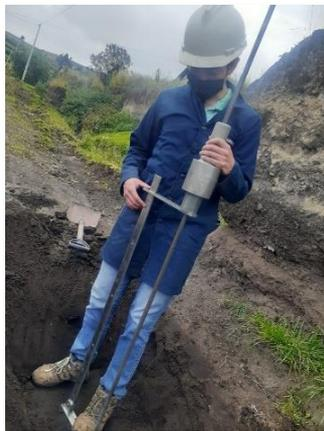
*Figura 24: Cono Dinámico de Penetración, M1-Cusubamba.
