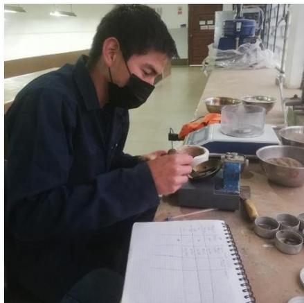
*Figura 27: Ensayo Limite Liquido.
