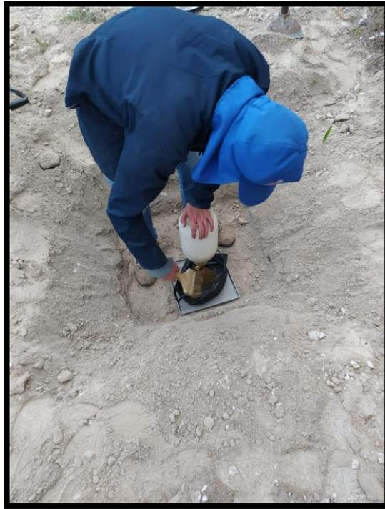
*Figura 62: Ejecución del Ensayo de Densidad de Campo en la Vía Rumipamba de Navas.*
