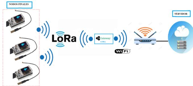
Figura 19: Arquitectura típica de un sistema Lora.
