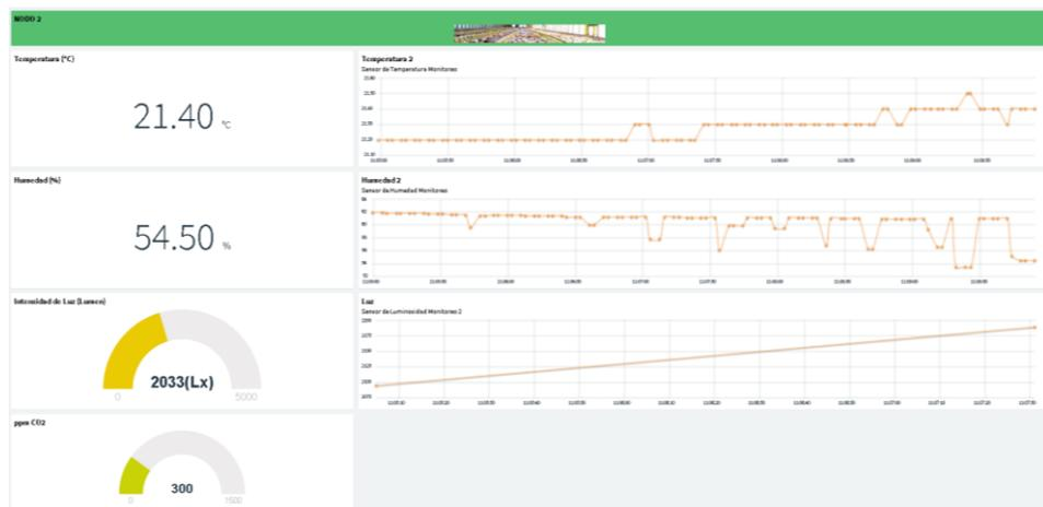
Figura 54. HMI de variables para el Nodo 2.
