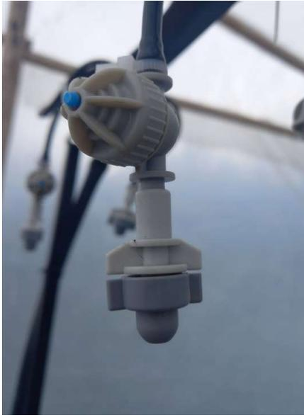
**Figura 20.** Nebulizador tipo coolnet.
