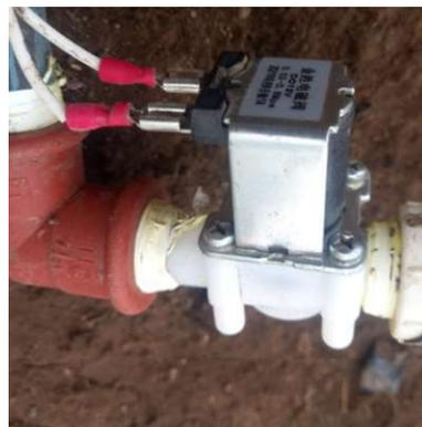
**Figura 28.** Válvula solenoide 12 Vcd.
