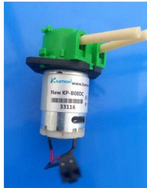
**Figura 29.** Mini bomba peristáltica de 60ml/min.
