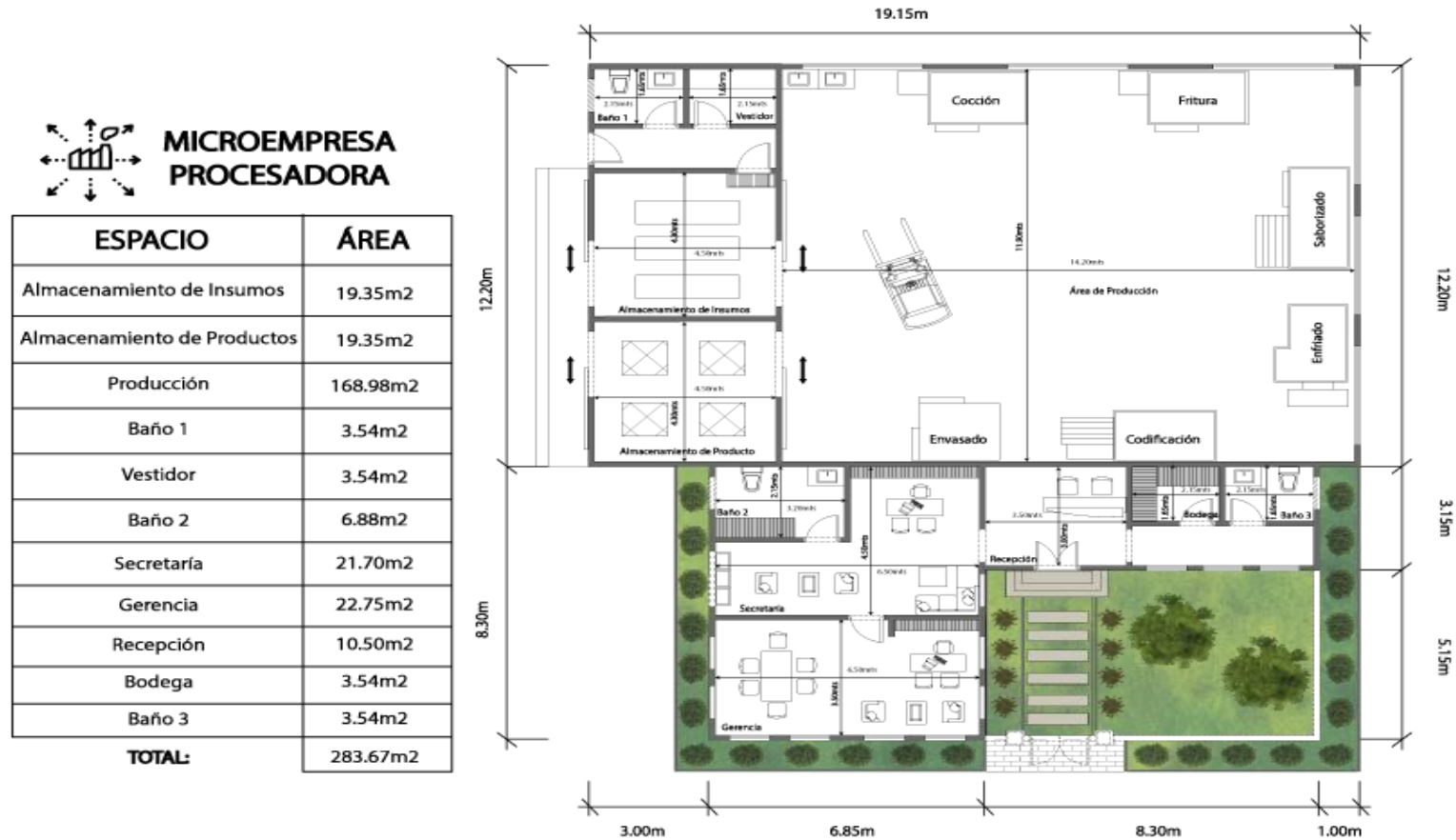
Figura 21. Diseño de la planta de la microempresa procesadora de habas fritas saborizadas
