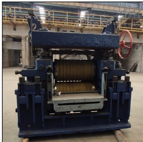
Figura 15. Caseta Pomini del tren de producción 1.
