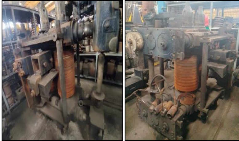
Figura 25. Caseta Danieli vertical 2 del tren de producción 2.
