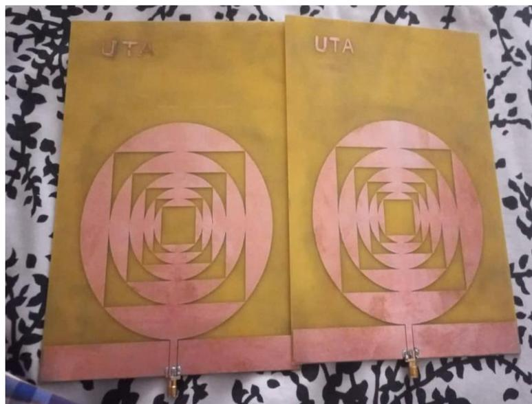
**Figura 3. 23.-** Ejemplares de antenas basada en geometría fractal.
