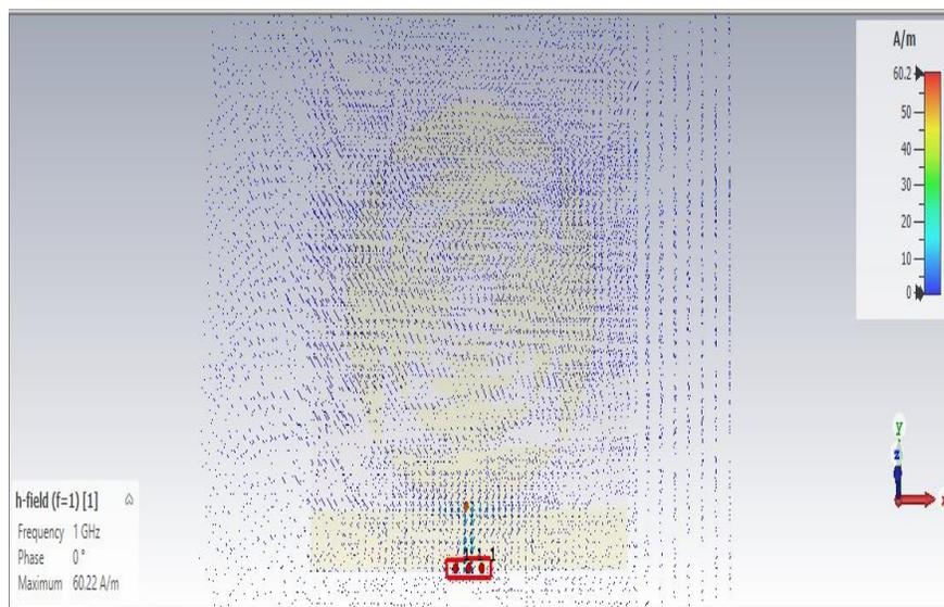
**Figura 3.18.-** Representación de campo magnético con cargas en reposo a 1GHz.
