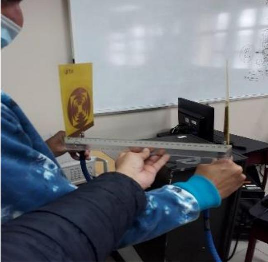
**Anexo 5.-** Pruebas de laboratorio con antenas fractales a 800MHz, 1GHz y 6GHz.
