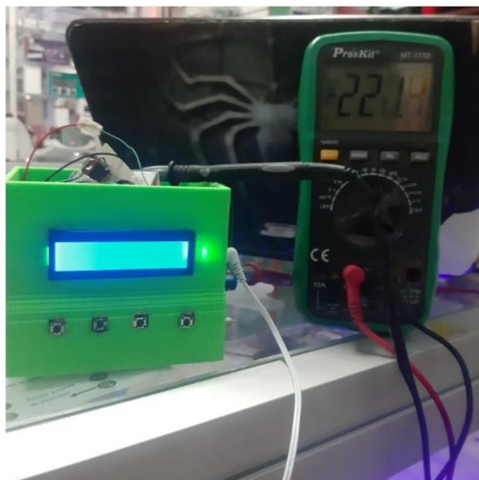
**Figura 51.** Medición de corriente del dispositivo
