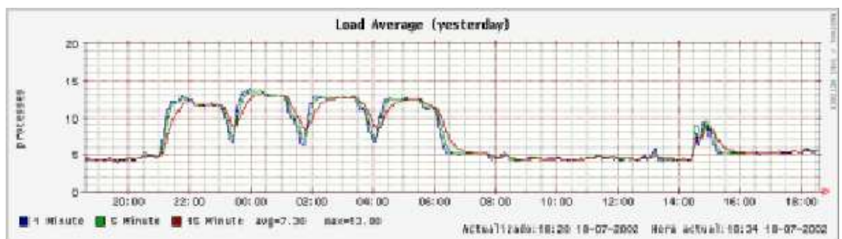
Figura 6. Carga del sistema. Número de procesos esperando CPU.
