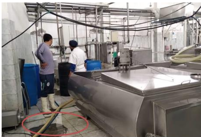
Figura 20. Líquidos en el piso en planta productiva.
