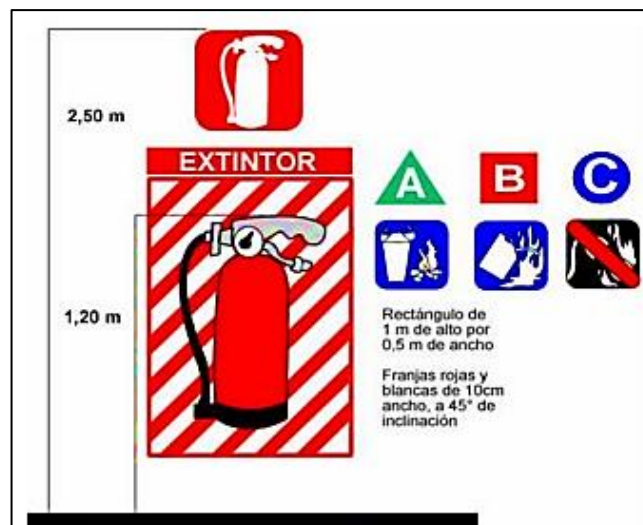
Figura 35. Señalética vertical de los extintores portátiles [58].
