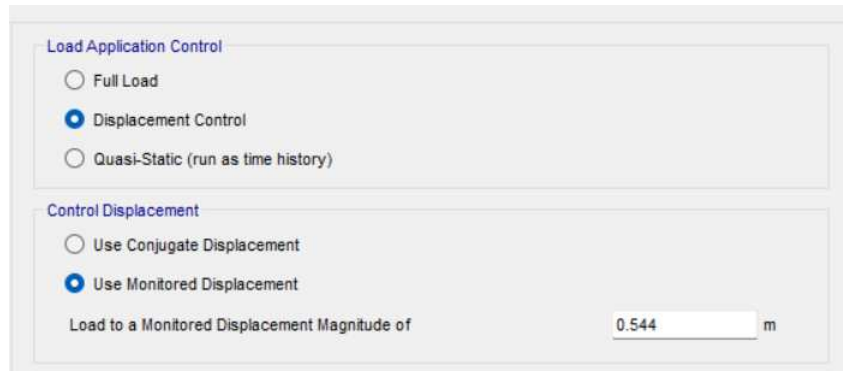
Figura 4.42. Control de aplicación de cargas y desplazamiento máximo
