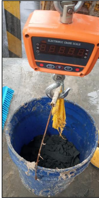
Figura 4-5. Determinación de la densidad del lodo activado residual.
