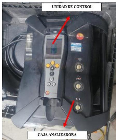
**Figura 13** Analizador de combustión marca Testo 350.
