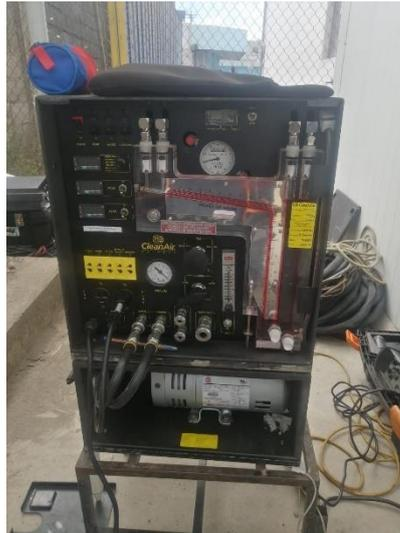
**Figura 15** Consola de control isocinético marca Clean Air.
