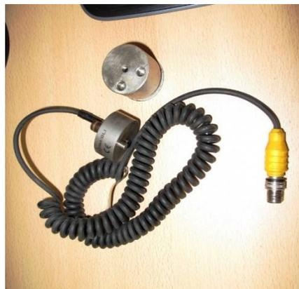
**Figura 19** Acelerómetro triaxial con cable enrollado de 6 in.
