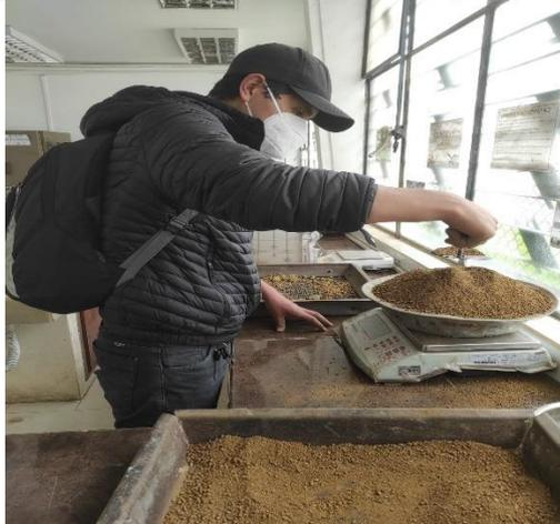
Pesaje de alrededor de 6000gr. de suelo en balanza digital, para realizar ensayo CBR.
