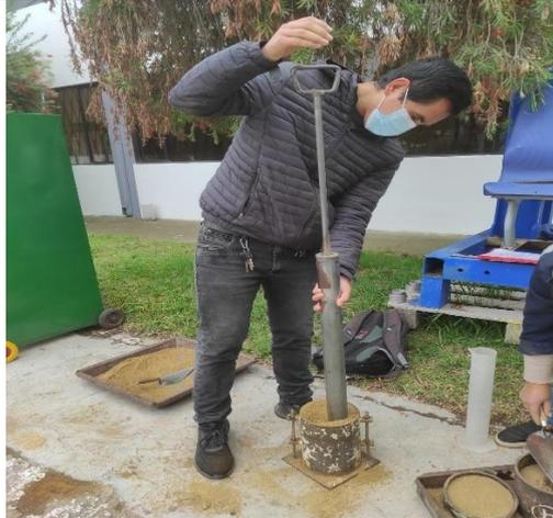
Compactación de la muestra de suelo con el contenido de humedad óptimo obtenido del ensayo Proctor Modificado, en 5 capas con 56 golpes.
