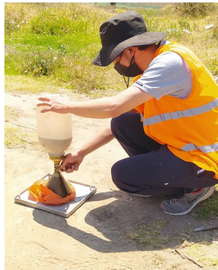
Fotografía 8: Ejecución del ensayo de Cono y Arena para determinar la densidad en campo.
