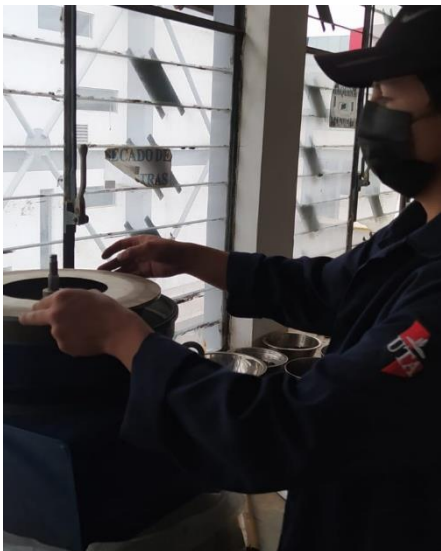
Fotografía 11: Colocación del filtro en la máquina centrifugadora para extracción de asfalto.
