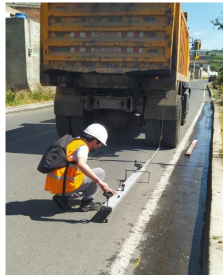
Fotografía 12: Medición de deflexiones del pavimento mediante el uso de la Viga Benkelman.
