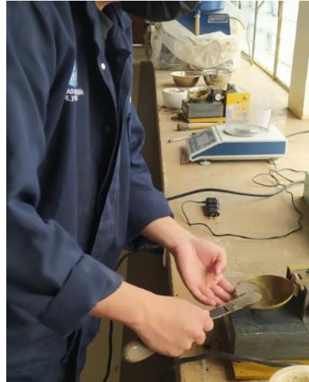
Fotografía 6: Determinación del Límite Líquido del suelo por medio de la Copa de Casagrande.
