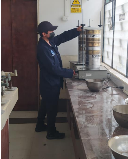
Fotografía 5: Colocación de tamices para el análisis granulométrico del suelo.
