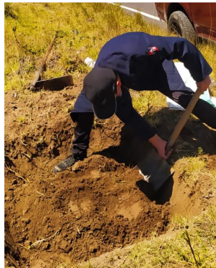
Fotografía 4: Excavación de calicatas para extracción de muestras alteradas del suelo.
