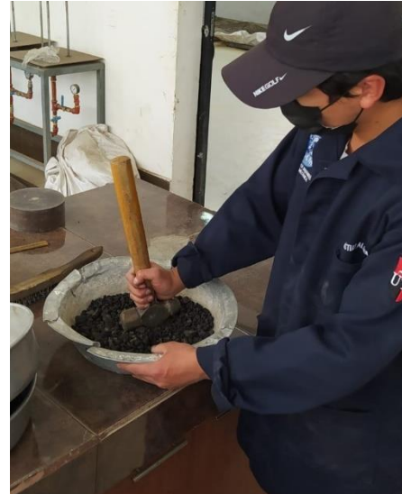
Fotografía 10: Disgregación de las muestras de asfalto.
