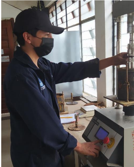
Fotografía 9: Ensayo de Carga-Penetración para determinar el valor de CBR del suelo.
