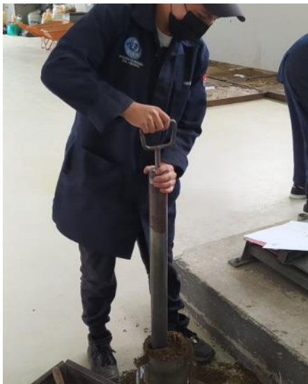
Fotografía 7: Compactación del suelo en el ensayo Proctor Modificado.
