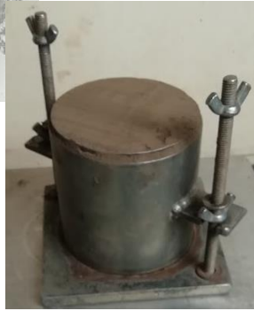
Molde de compactación, retorta, collarín y base del molde
