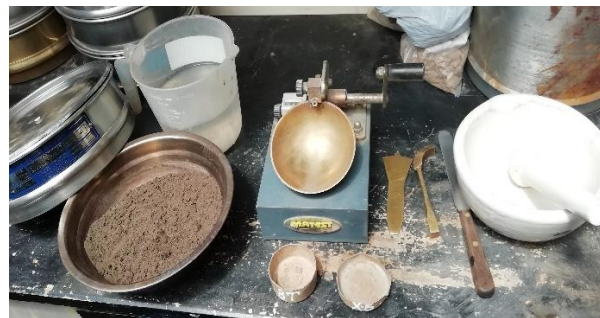
Figura 22 Materiales para los Límites de Atterberg
