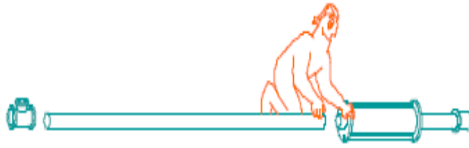
Fig. 6.67 Colocación el tubo de descarga.
