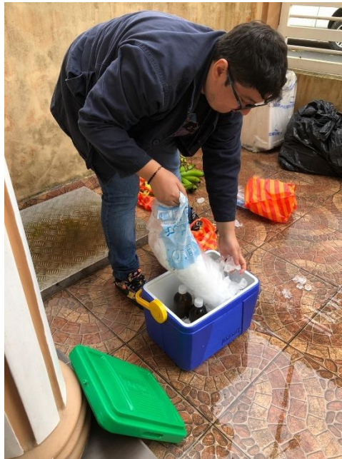
Fig. 24 Empacado de muestras del agua residual proveniente del prototipo del sistema de filtración.
