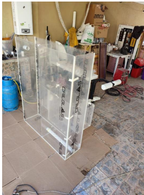
Fig. 14 Filtro lento convencional y la caja de carbón activo unidos en una sola pieza.
