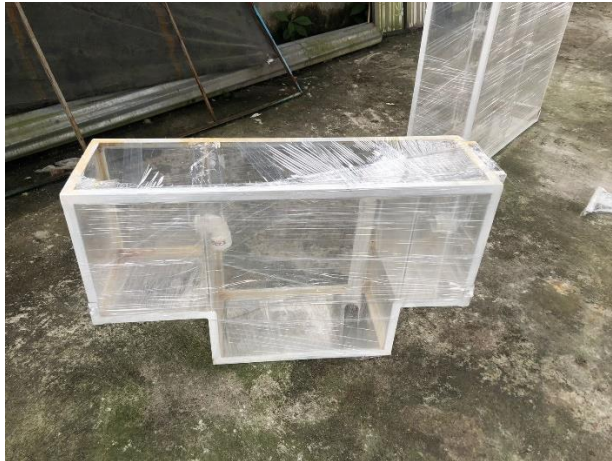
Fig. 15 Caja de revisión, trampa de grasas y cajas de transición.
