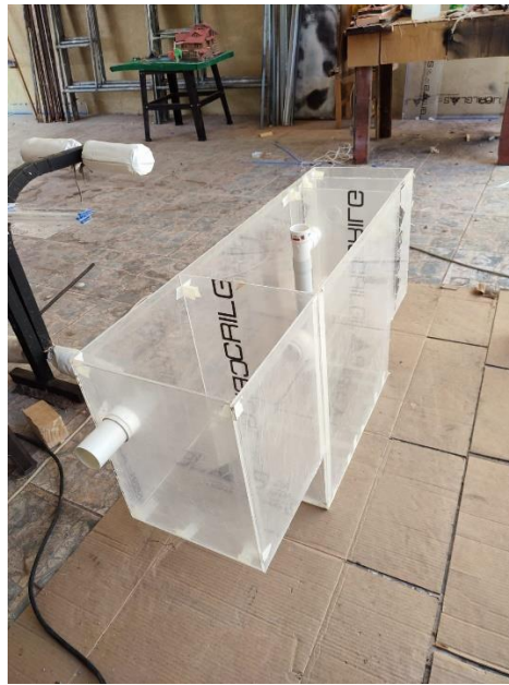
Fig. 13 Caja de revisión, trampa de grasas y cajas de transición unidas en una sola pieza.
