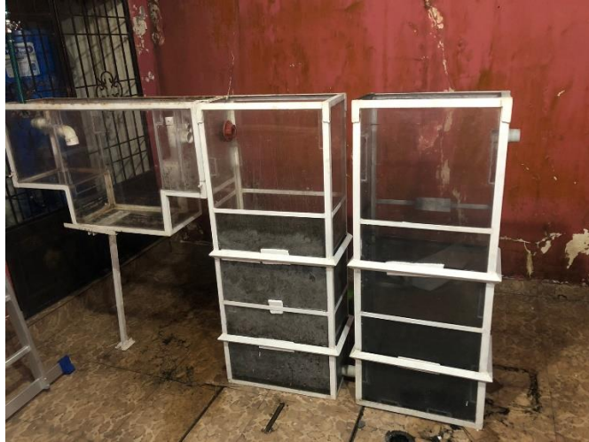
Fig. 17 Diseño final del prototipo del sistema de filtración.
