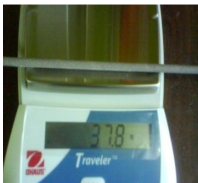
Figura 4.1 Pesaje en gramos de E7018 humedecido
