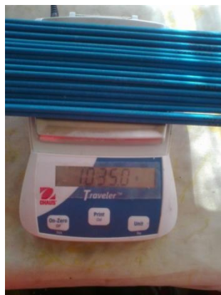
Figura 4.4 Pesaje de 33 Electrodos 6013 humedecidos
