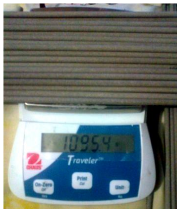
Figura 4.2 Pesaje de 29 Electrodo 7018 humedecidos
