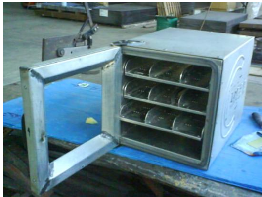
Figura 6.31 Estructura del horno
