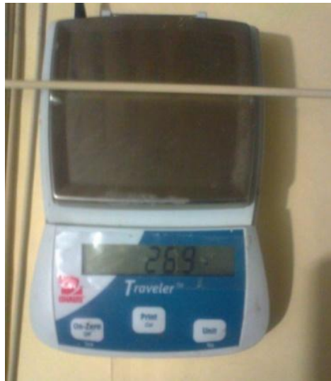
Figura 4.11 Pesaje en gramos de E6011 dejado a la intemperie
