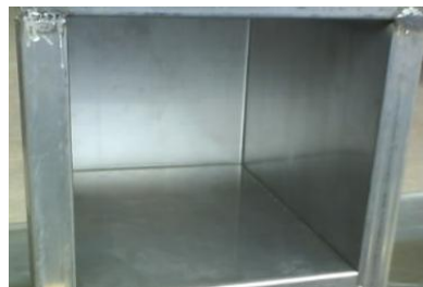
Figura 6.18 Estructura frontal de la cámara de calentamiento
