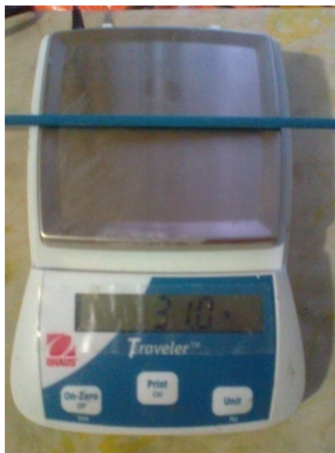
Figura 4.9 Pesaje en gramos de E6013 dejados a la intemperie
