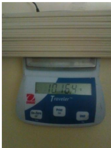
Figura 4.12 Pesaje de 38 Electrodos 6011 dejados a la intemperie
