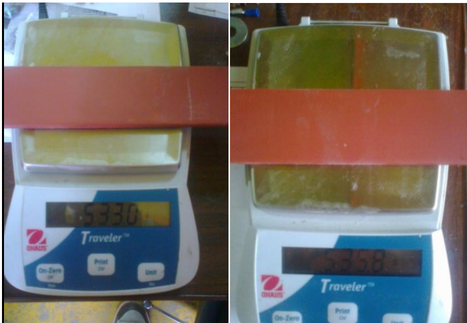
Figura 4.16 Peso de Platinas a ser soldadas con E7018 sacados directamente de la funda
