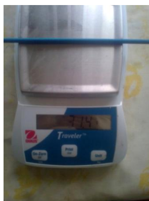
Figura 4.3 Pesaje en gramos de E6013 humedecido
