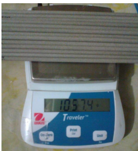
Figura 4.8 Pesaje de 29 Electrodo 7018 dejados a la intemperie
