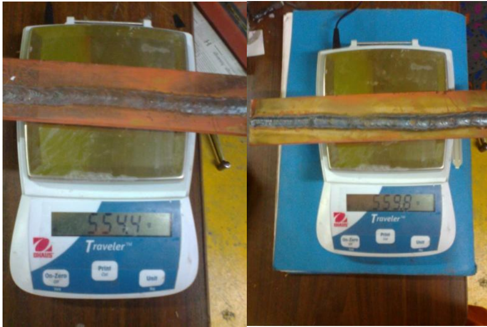
Figura 4.15 Peso de platinas soldadas con E7018 previamente dejado a la intemperie por dos semanas
