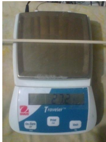
Figura 4.5 Pesaje en gramos de E6011 humedecido
