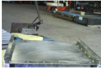
Figura 6.19 Estructura superior de la cámara de calentamiento
