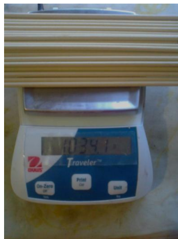
Figura 4.6 Pesaje de 38 Electrodo 6011 humedecidos
