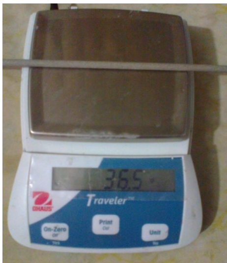
Figura 4.7 Pesaje en gramos de E7018 dejado a la intemperie
