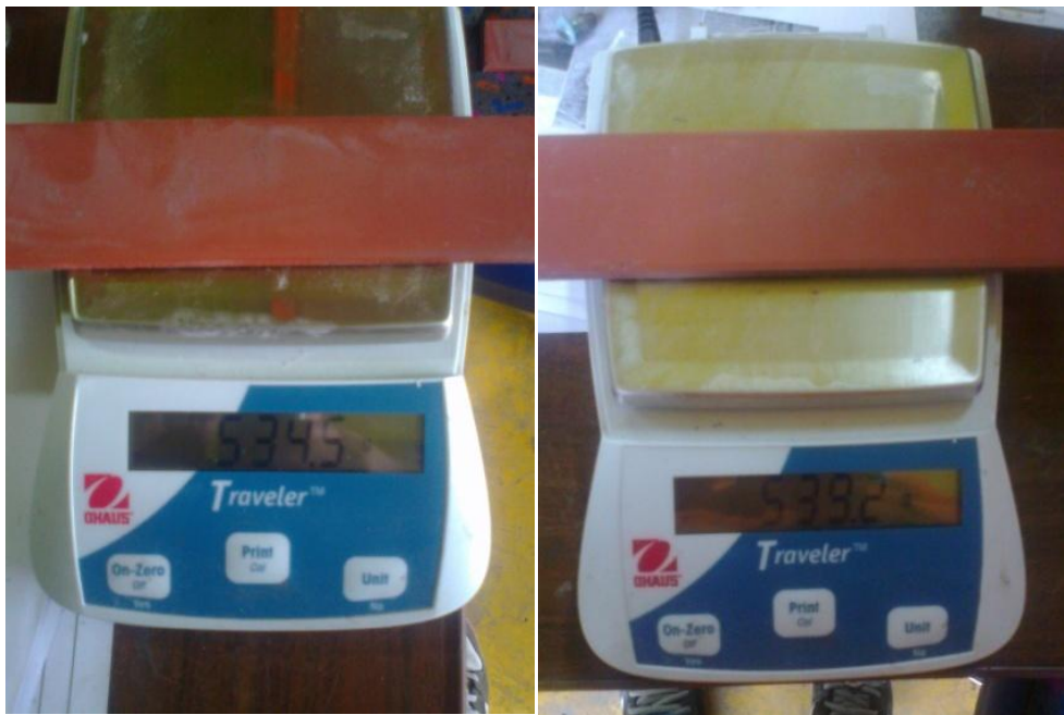
Figura 4.14 Peso de platinas a ser soldadas con E7018 previamente dejado a la intemperie por dos semanas
