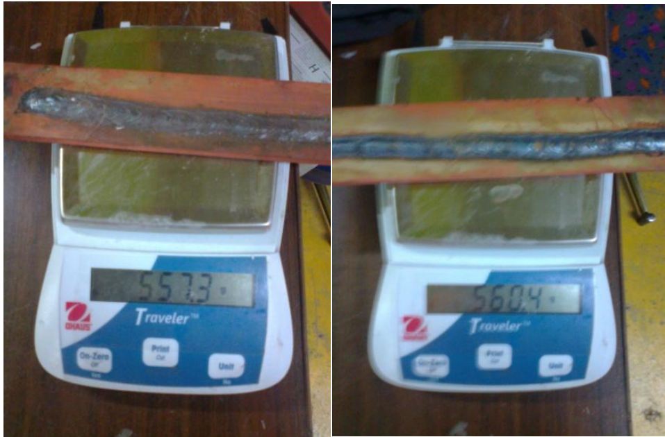
Figura 4.17 Peso de Platinas soldadas con E7018 sacados directamente de la funda
