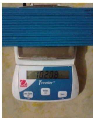
Figura 4.10 Pesaje de 33 Electrodo 6013 dejados a la intemperie
