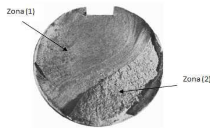
Figura 2. 2 Zonas características del fallo por fatiga (Fuente: CAZAUD R., (1957), “La Fatiga de los Metales”, Ed. Aguilar S.A., México)
