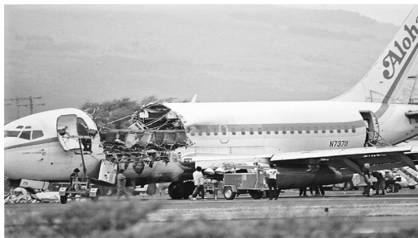
Figura2. 1 Fallas por fatiga en un fuselaje de avión. (Fuente: CAZAUD R., (1957), “La Fatiga de los Metales”, Ed. Aguilar S.A., México)
