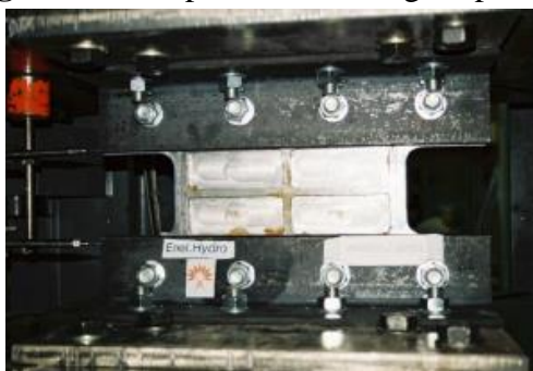
Figura 12. Disipadores de energía tipo SLB
