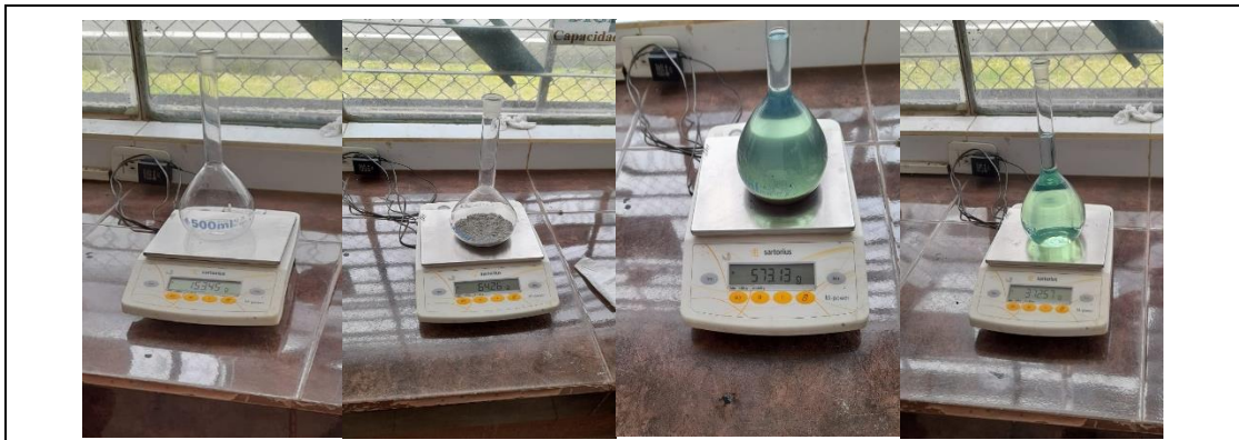
Fotografía 11. Densidad real del cemento
