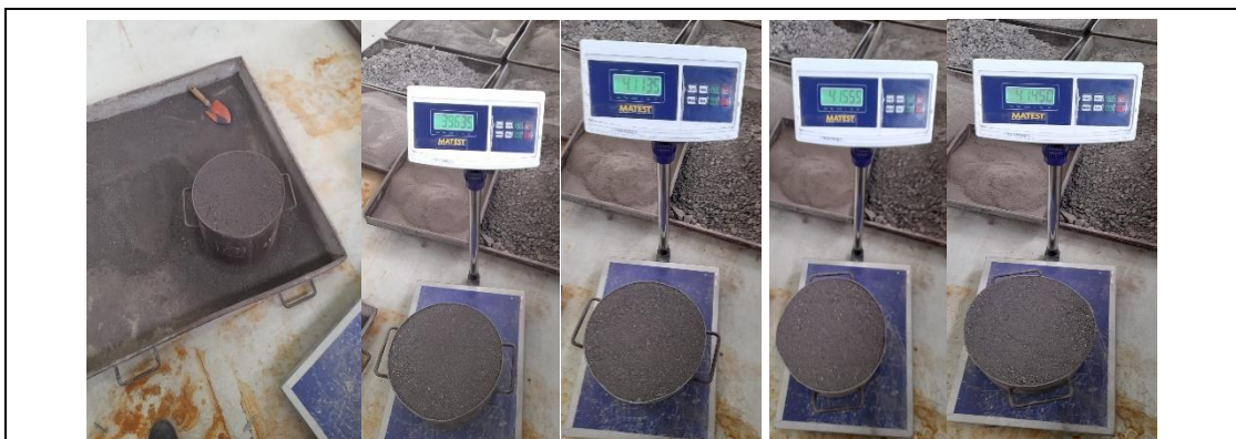
Fotografía 13. Densidad aparente suelta y compactada del agregado fino
