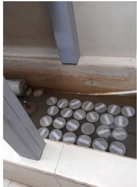
Fotografía 29. Curado de las probetas de hormigón
