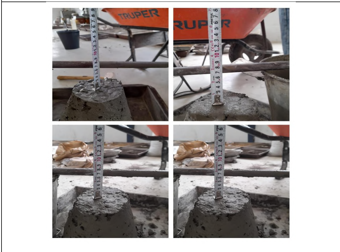
Fotografía 24. Medición del Asentamiento
