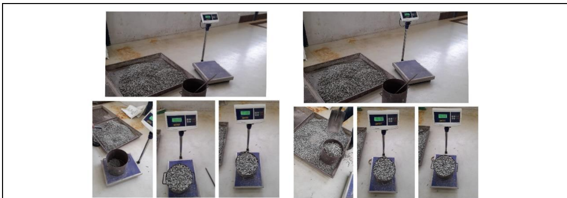
Fotografía 12. Densidad aparente suelta y compactada del agregado grueso
