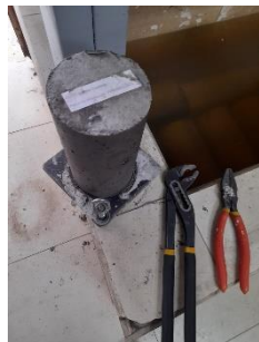
Fotografía 28. Desencofrado de los cilindros de hormigón
