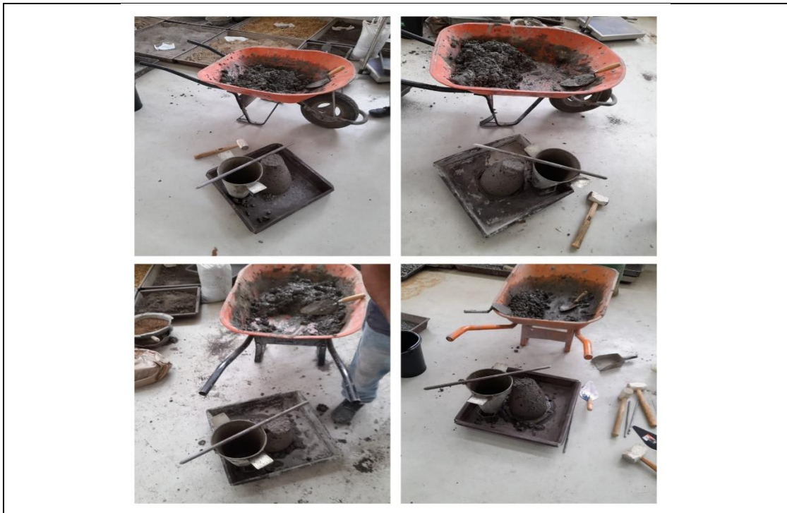
Fotografía 23. Ensayo de Cono de Abrams
