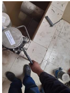
Fotografía 26. Colocación del hormigón por capas
