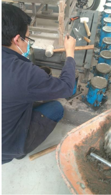
Fotografía 26. Colocación del hormigón por capas
