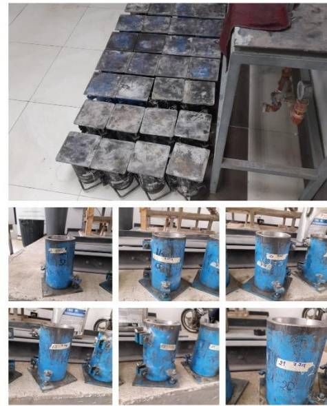
Fotografía 20. Moldes de acero para cilindros de hormigón
