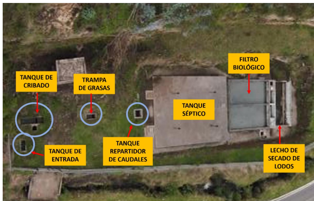
Imagen 7. Procesos unitarios en la PTAR del sector Infiernillo.
