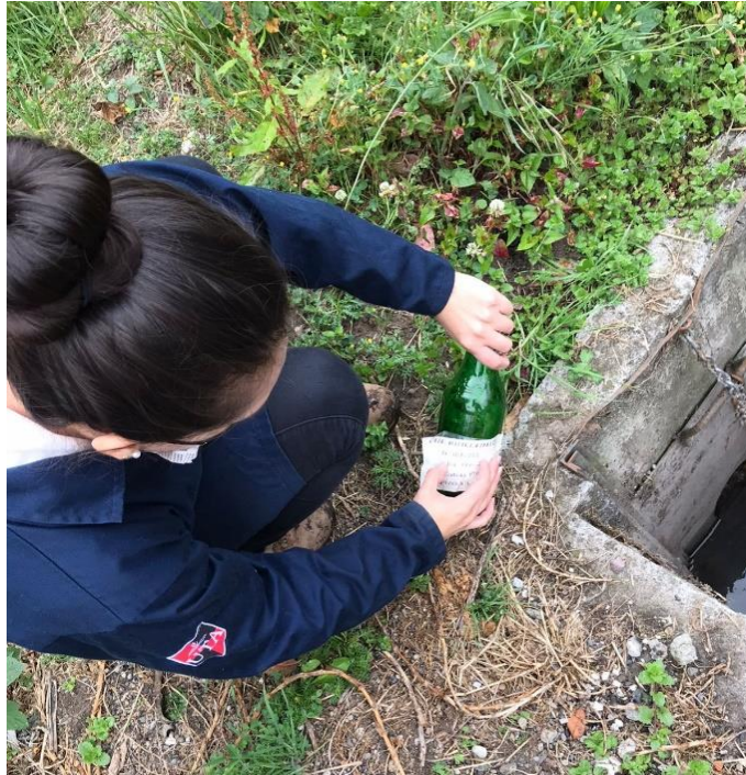
Imagen 15. Recolección de muestras de agua residual del afluente de la PTAR. Fuente: Autora
