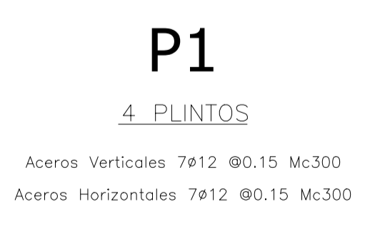
P1 4 PLINTOS Aceros Verticales 7φ12 @0.15 Mc300 Aceros Horizontales 7φ12 @0.15 Mc300 UBICACIÓN A1, A2, B1, B2
