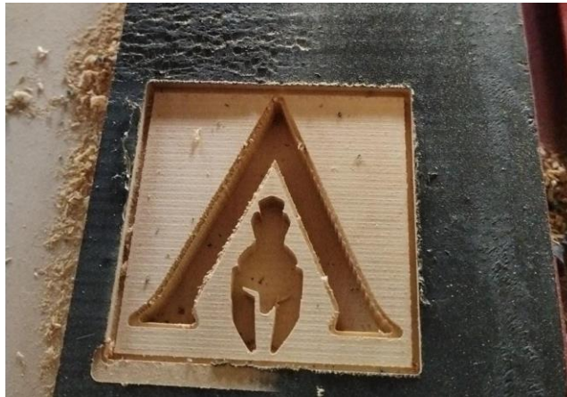
Figura 3-61: Tallado de figuras complejas
