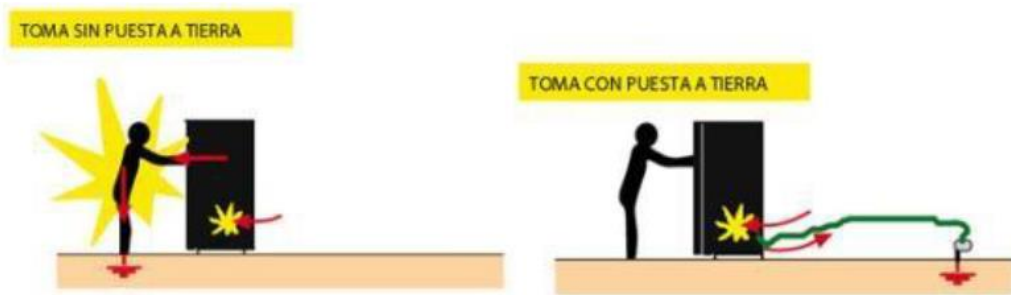
Figura 26: Esquema de tableros con y sin puesta a tierra. [19]
