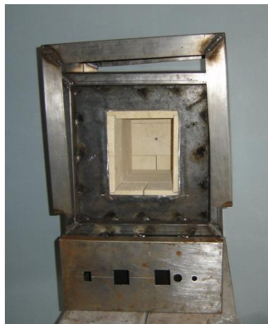
Figura 6.13 Carcasa del horno eléctrico.
