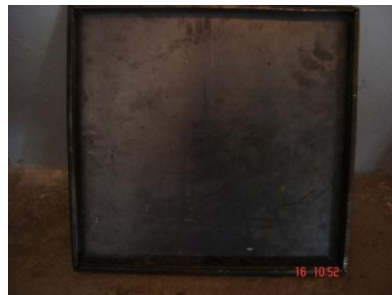
Figura 6.3 Soporte de ladrillos refractarios Elaborado: Jaime Toasa
