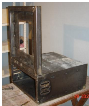
Figura 6.7 Estructura principal del horno eléctrico
