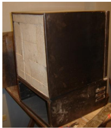
Figura 6.12 Cubierta de ladrillos refractarios
