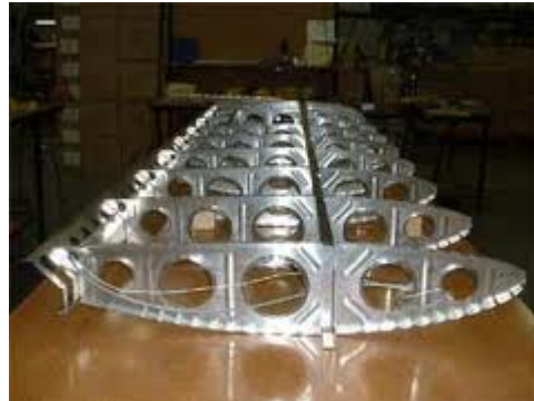
Ilustración 4. 10 Alas construidas con aluminio. (Fuente: Autora)
