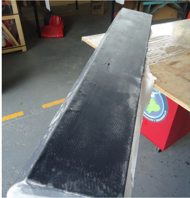
Ilustración 6.42 Construcción de superficies móviles. (Fuente: Autora)
