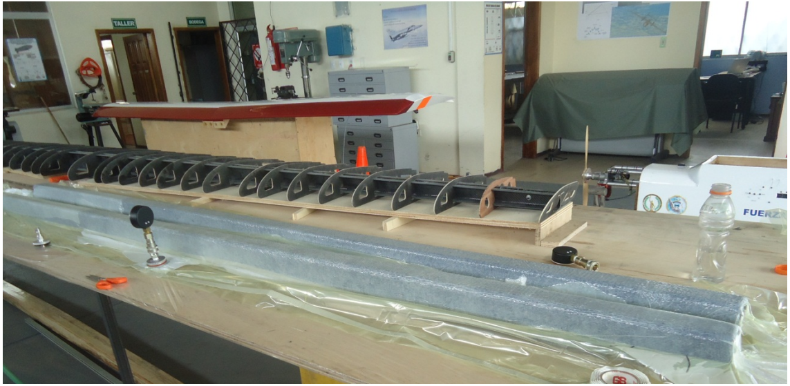
Ilustración 6.31 Proceso de laminado de la viga secundaria. (Fuente: Autora)
