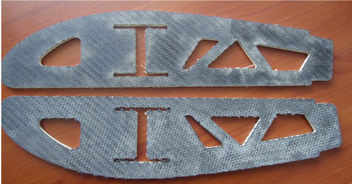
Ilustración 6.33 Costillas para estructura del ala Aeronave Fénix (Fuente: Autora)
