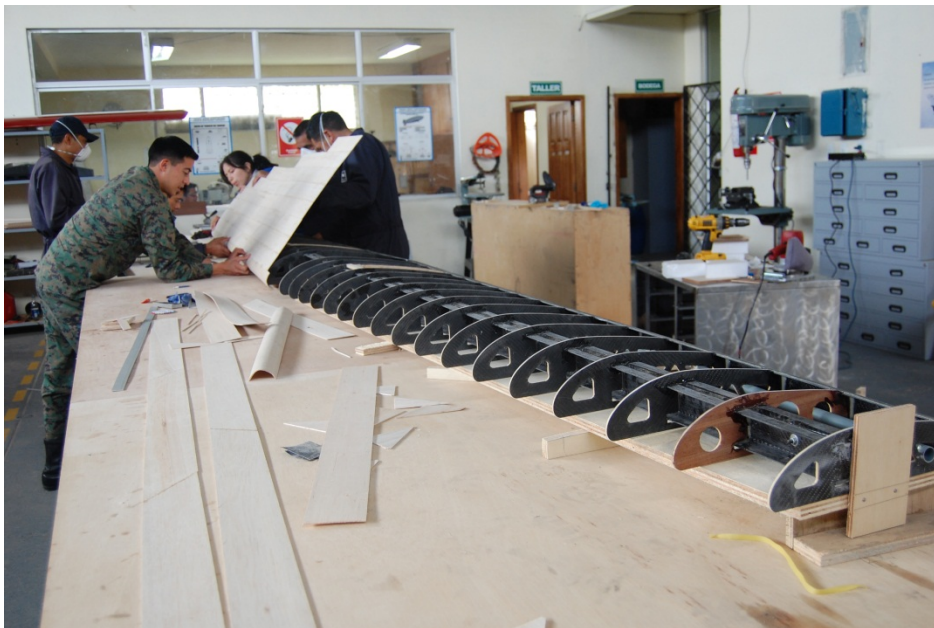
Ilustración 6.38 Enchapado de la estructura alar. (Fuente: Autora)
