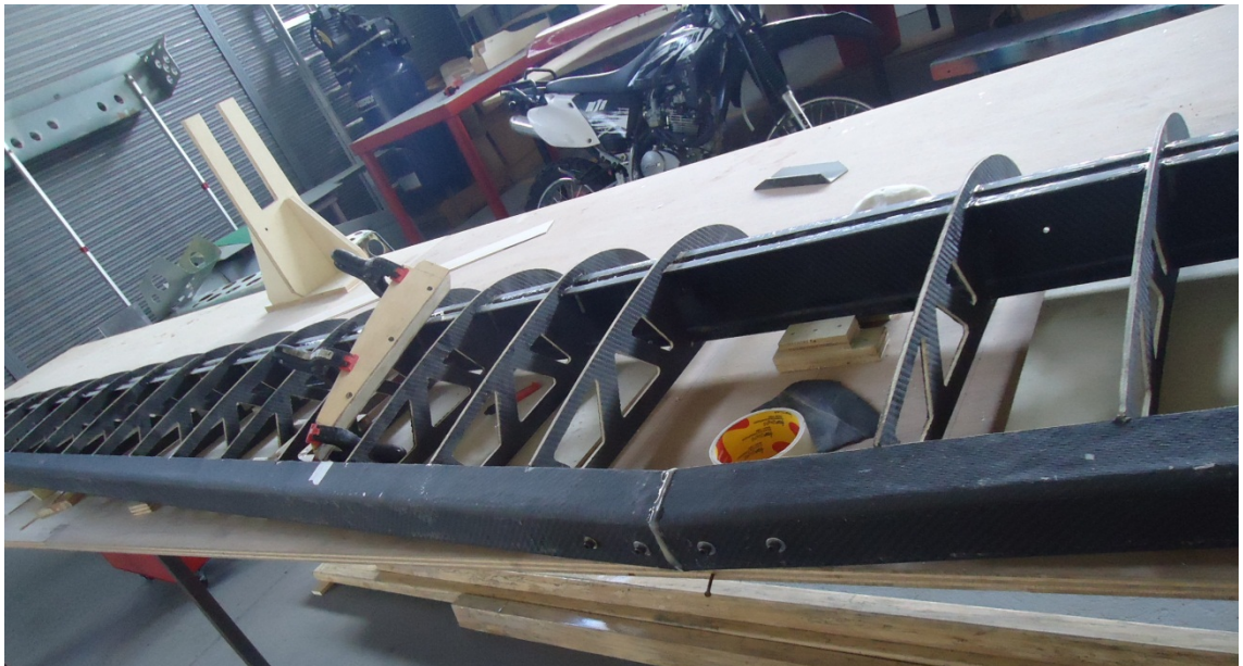
Ilustración 6.35 Costillas para estructura del ala Aeronave Fénix (Fuente: Autora)
