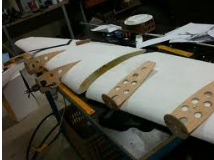
Ilustración 4. 9 Alas construidas mediante uso de foam. (Fuente: Autora)
