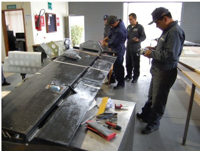
Ilustración 6.43 Colocación de planos móviles en la estructura alar. (Fuente: Autora)
