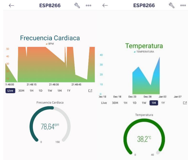
Figura 44. Prueba de funcionamiento del dispositivo electrónico
