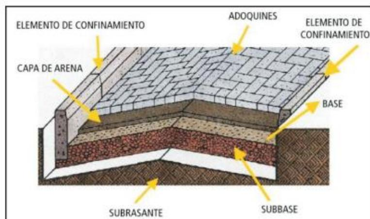
*Fig. 7. Pavimento de adoquines [18].*
