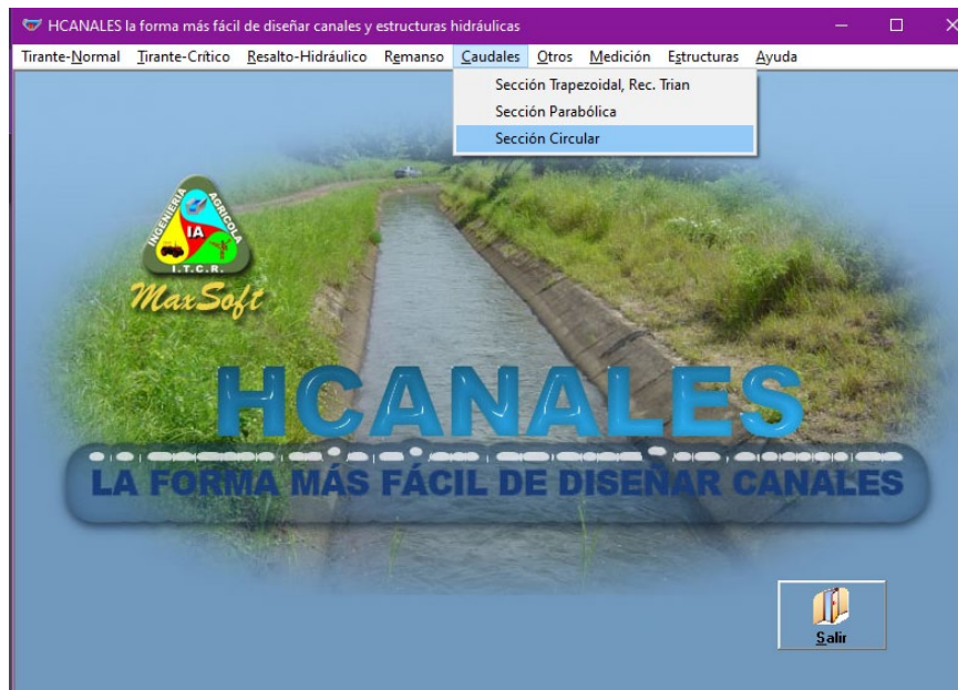
Ilustración 24: ventana principal del programa, se muestra como ingresar para calcular sección a tubería completamente llena.
