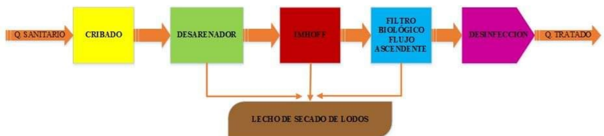
Ilustración 15: etapas para tratamiento de aguas residuales.
