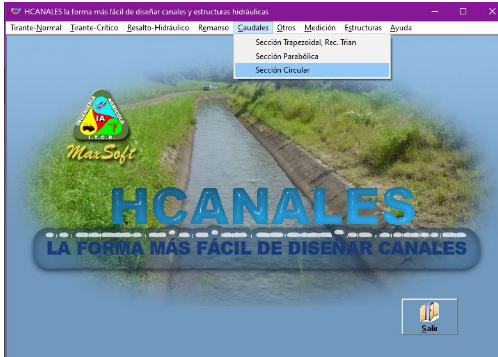
Ilustración 28: ventana principal del programa, se muestra como ingresar para calcular sección a tubería completamente llena.
