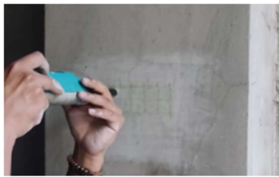
Figura 12 Ensayo esclerométrico con la norma ASTM C805
