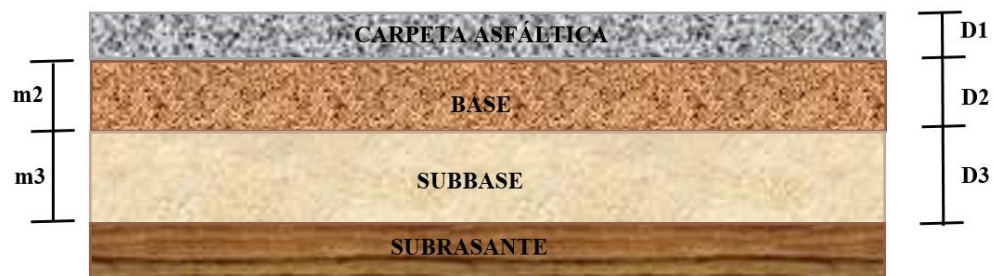
Figura 15. Coeficiente de la estructura del pavimento
