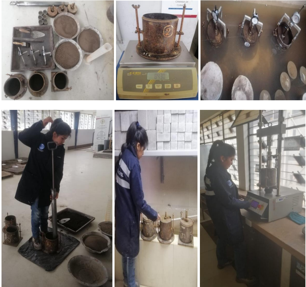
Ensayos del CBR
