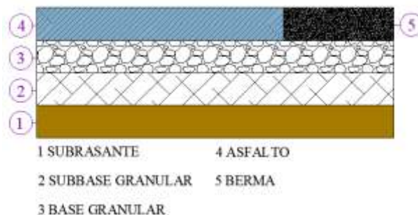
Gráfico 2. Sección transversal de pavimento flexible.
