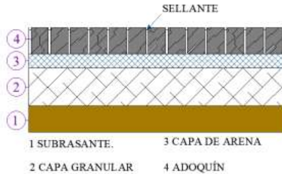
Gráfico 5. Sección transversal de pavimento articulado.
